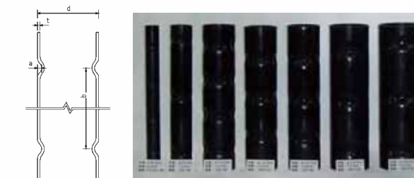
段付き鋼管はソイルコラムがアルカリ環境下であることや、かぶり厚さが15cm以上あること等により、腐食代は見込んでいません。
