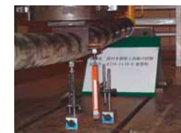
タイガーパイル曲げ試験状況 (試験前)
